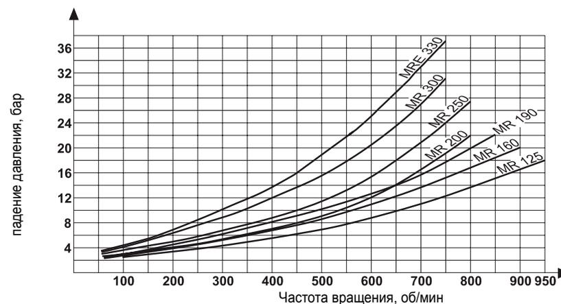
**РАБОЧАЯ ДИАГРАММА** (средние значения) измерено при  $v = 36 \text{ мм}^2/\text{с}$ ;  $t = 45^\circ\text{C}$ ;  $p_{\text{выходн.}} = 0 \text{ бар}$
