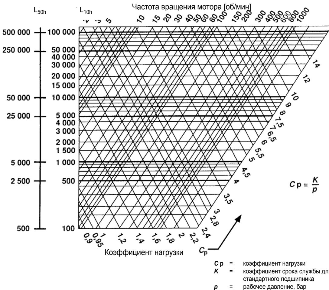
L<sub>10h</sub> представляет собой теоретическое значение срока службы, обычно достигаемое или превышаемое 90% подшипников. 50% подшипников достигают значения L<sub>50h</sub>, которое в 5 раз больше L<sub>10h</sub>.
