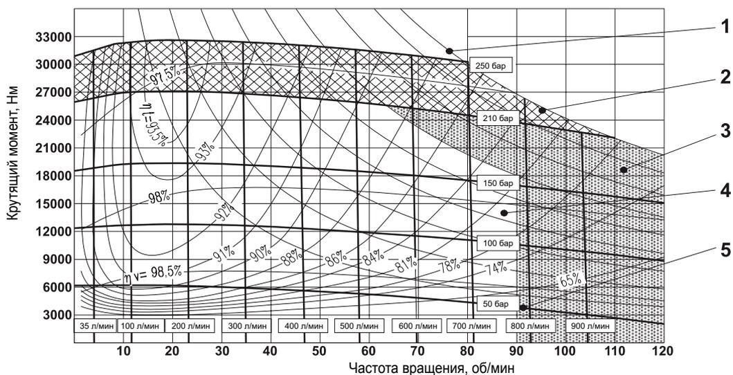
**РАБОЧАЯ ДИАГРАММА** (средние значения) измерено при  $v = 36 \text{ мм}^2/\text{с}$ ;  $t = 45^\circ\text{C}$ ;  $p_{\text{выходн.}} = 0 \text{ бар}$
