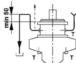
Контур охлаждения для непрерывной работы с высокой мощностью.
