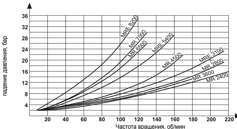
Минимальное давление подпора при эксплуатации в режиме насоса
